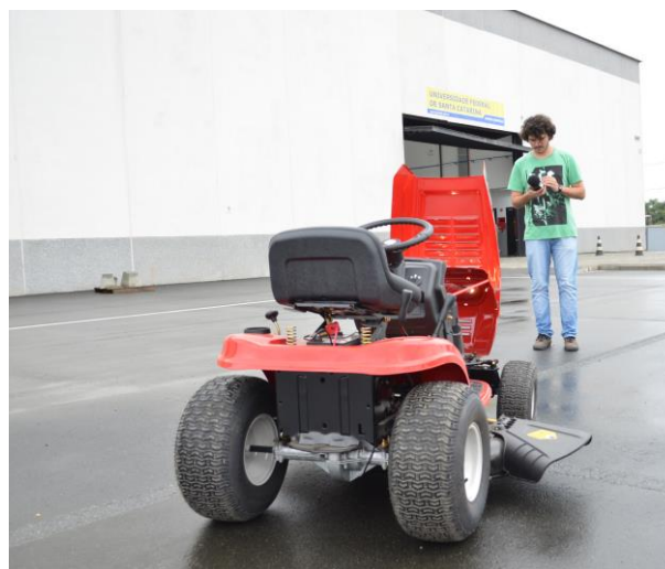
Figura 8 – Ilustração de medição acústica realizada na pista de teste.
